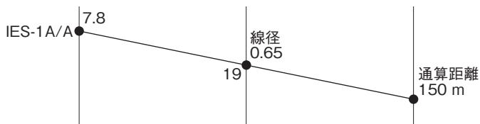
IES-1A/Aの●点と線型0.65mmの●点を直線で引き、その延長に求める通達距離150mが得られます。
