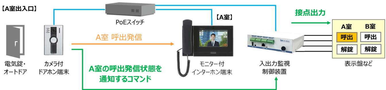
パターン② アナログ信号（接点入力）をIP信号（コマンド）に変換
