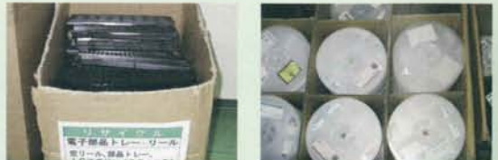
リターナブル（回収・再利用）される電子部品保護用のトレー、リール
