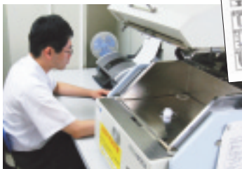
蛍光X線分析装置による測定
